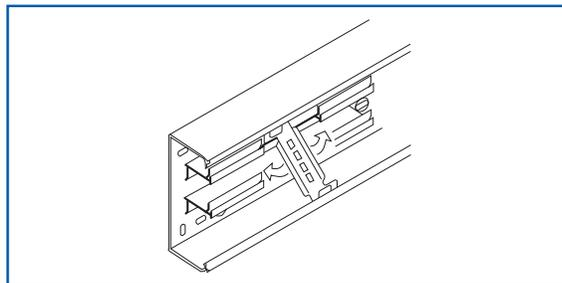
Nel caso di utilizzo delle traversine TR-E in un canale attrezzato con separatori, qualora fosse necessario irrigidire al massimo il sistema, è opportuno tagliare i separatori in corrispondenza delle traversine per consentire l'abbassamento delle spondine di irrigidimento.
